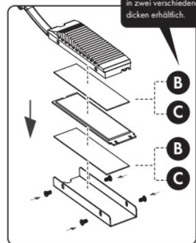
2 Installieren Sie die M.2 NVMe SSD mit Wärmeleitpad und befestigen Sie wieder die Halterung mit 4 Schrauben
