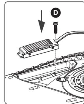
3 Platzieren Sie vorsichtig die M.2 SSD mit dem Heatpipe Kühler in den M.2 Slot und befestigen Sie sie mit einer Schraube.
