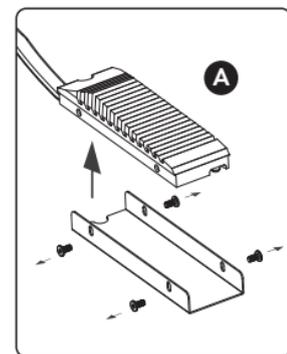
1 Entfernen Sie alle 4 Schrauben und nehmen Sie die Halterung von Kühlkörper ab
